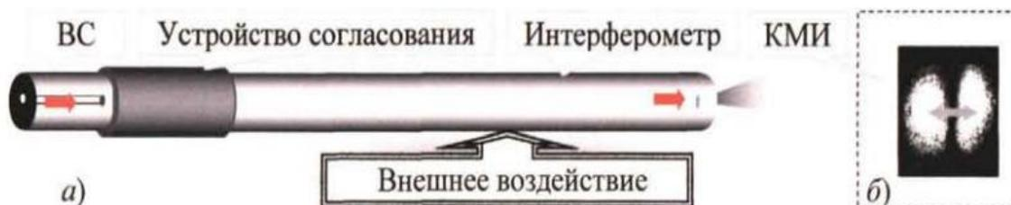
Рисунок 13 - Схема одноволоконного двухмодового интерферометра (а). Фотография картины межмодовой интерференции на выходе ОДИ (б)
